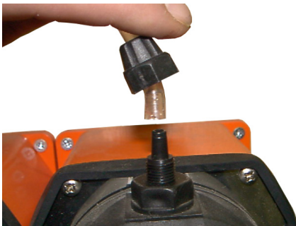
Schieben Sie die Kontra -Mutter über den Schlauch.
