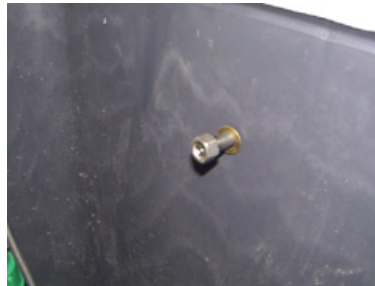
Montieren Sie an der Innenseite des Fasses den Gummiring und die Kontra-Mutter.
