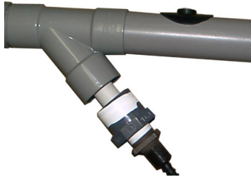
Drehen Sie die EC -Elektrode in den Leimring.
