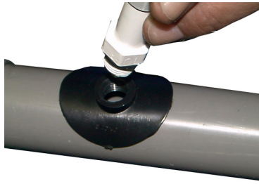
Umwickeln Sie die pH -Elektrode mit Installationstape (Teflontape).
