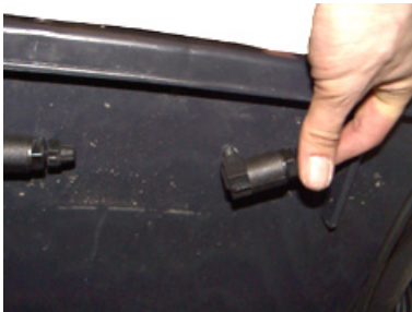
Bohren Sie für jede Injektor ein Loch mit 10 mm Durchmesser. Stecken Sie die Injektoren von aussen hier hinein.
